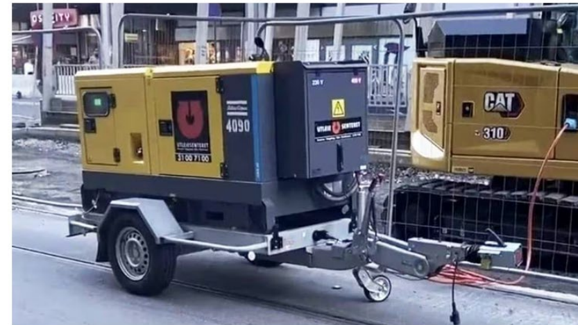
Dieselaggregatet ladet en el-gravemaskin i Stenersgata i Oslo da den ikke kom seg til ladestasjonen. FOTO: PRIVAT
